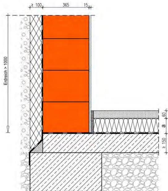
Die Berechnung des längenbezogenen Wärmedurchgangskoeffizienten erfolgt in Abhängigkeit unterschiedlicher Dicken  $a$  der Estrichdämmung und unterschiedlicher Wärmeleitfähigkeiten des Kellermauerwerks mit der Wanddicke 365 und einer Perimeterdämmung mit einer Dicke von mindestens 100 mm. Der Temperatur-Korrekturfaktor  $F_{\text{bw}}$  und  $F_{\text{bf}}$  beträgt 0,6.
