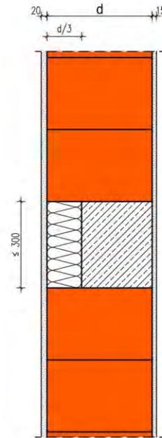
Die Berechnung des langenzugezogenen Warmedurchgugskoeffizienten erfolgt in Abhangigkeit unterschiedlicher Wanddicken d und Warmeleitfahigkeiten des Mauerwerks. Die Dicke der Warmedammung vor der 300 mm breiten Stahlbetonstutze betragt d/3 d.h. 100 - 160 mm, deren Warmeleitfahigkeit 0,035 W/(m·K).
