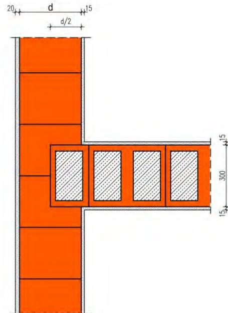
Die Berechnung des längenbezogenen Wärmedurchgangskoeffizienten erfolgt in Abhängigkeit unterschiedlicher Wanddicken  $d$  und Wärmeleitfähigkeiten des Außenmauerwerks. Die 30 cm dicke Wohnungstrennwand ist als Füllziegelwand mit einer Wärmeleitfähigkeit von  $0,96 \text{ W/(m}\cdot\text{K)}$  ausgeführt und etwa  $d/2$  von der Raumseite eingebunden.
