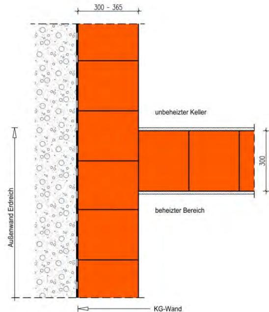
Die Berechnung des längenbezogenen Wärmedurchgangskoeffizienten erfolgt in Abhängigkeit unterschiedlicher Wärmeleitfähigkeiten des Außen- und Innenmauerwerks. Die Systemgrenze der Wände verläuft außenseitig auf der Kaltseite (Erdreich bzw. unbeheizter Keller). Der Temperaturkorrekturfaktor  $F_{\text{bw}}$  und  $F_{\text{bf}}$  beträgt 0,6. Die Rechenergebnisse gelten für Wanddicken der Außenwände zwischen 300 und 365 mm.
