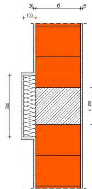
Die Berechnung des längenbezogenen Wärmedurchgangskoeffizienten erfolgt in Abhängigkeit unterschiedlicher Wanddicken  $d$  und Wärmeleitfähigkeiten des Mauerwerks. Die Dicke der Wärmedämmung vor der 300 mm breiten Stahlbetonstütze beträgt  $d/3$  d.h. 100 - 160 mm, deren Wärmeleitfähigkeit  $0,035 \text{ W/(m}\cdot\text{K)}$ . Im Bereich von Anschlüssen zu Flachdächern sind gfs. besondere Maßnahmen erforderlich, um die Mindestoberflächentemperatur an der Innenoberfläche sicher zu stellen.
