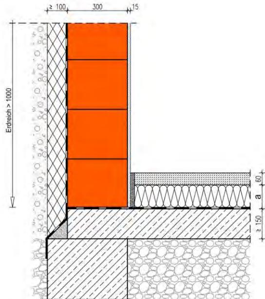
Die Berechnung des längenbezogenen Wärmedurchgangskoeffizienten erfolgt in Abhängigkeit unterschiedlicher Dicken  $a$  der Estrichdämmung und unterschiedlicher Wärmeleitfähigkeiten des Kellermauerwerks mit der Wanddicke 300 und einer Perimeterdämmung mit einer Dicke von mindestens 100 mm. Der Temperatur-Korrekturfaktor  $F_{\text{bw}}$  und  $F_{\text{bf}}$  beträgt 0,6.
