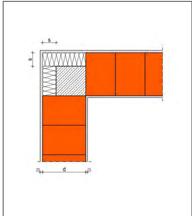
Die Berechnung des längenbezogenen Wärmedurchgangskoeffizienten erfolgt in Abhängigkeit unterschiedlicher Wanddicken  $d$  und Dicken  $a$  der zusätzlichen Wärmedämmung (035) der Stütze. Im Bereich von 3-dimensionalen Außenwandecken z.B. an Flachdächern sind gfs. besondere Maßnahmen erforderlich, um die Mindestoberflächentemperatur an der Innenoberfläche sicher zu stellen.
