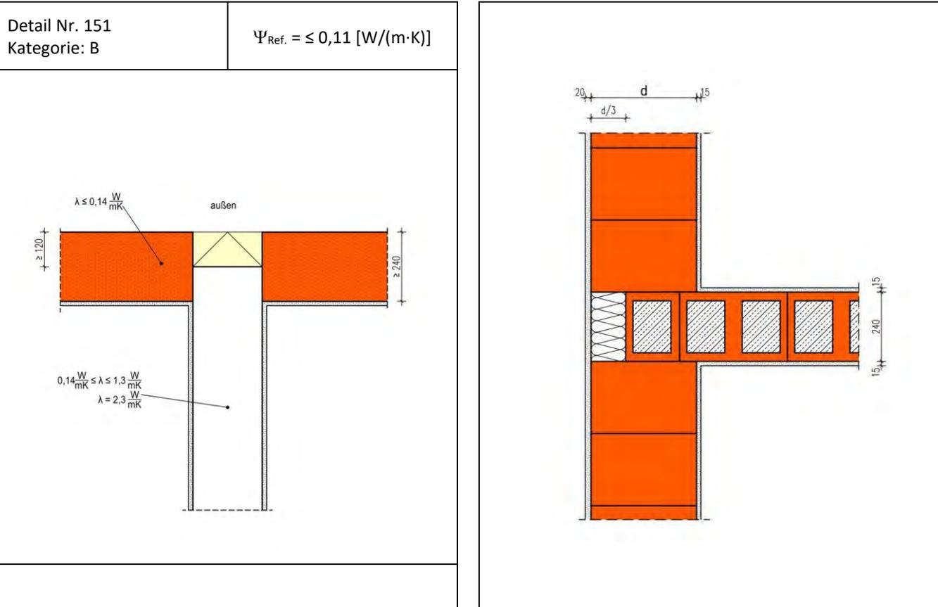
Die Berechnung des längenbezogenen Wärmedurchgangskoeffizienten erfolgt in Abhängigkeit unterschiedlicher Wanddicken  $d$  und Wärmeleitfähigkeiten des Außenmauerwerks. Die 24 cm dicke Wohnungstrennwand ist als Füllziegelwand mit einer Wärmeleitfähigkeit von  $0,96 \text{ W/(m}\cdot\text{K)}$  ausgeführt und mit einer  $d/3$  Stirndämmung der Wärmeleitfähigkeit  $0,035 \text{ W/(m}\cdot\text{K)}$  in die Außenwand eingebunden.
