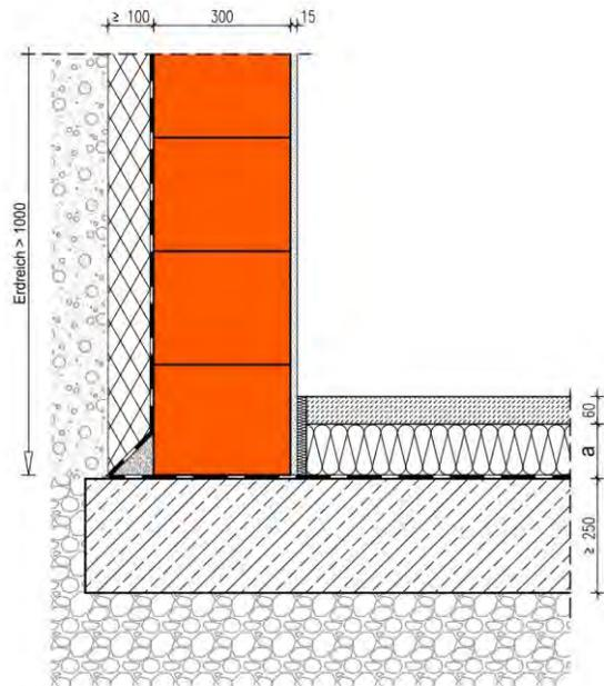
Die Berechnung des längenbezogenen Wärmedurchgangskoeffizienten erfolgt in Abhängigkeit unterschiedlicher Dicken  $a$  der Estrichdämmung und unterschiedlicher Wärmeleitfähigkeiten des Kellermauerwerks mit der Wanddicke 300 mm und einer Perimeterdämmung mit einer Dicke von mindestens 100 mm. Der Temperatur-Korrekturfaktor  $F_{bw}$  und  $F_{bf}$  beträgt 0,6.
