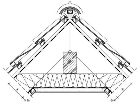
Die Berechnung des längenbezogenen Wärmedurchgangskoeffizienten erfolgt in Abhängigkeit unterschiedlicher Dämmstoffdicken  $s$  und Wärmeleitfähigkeiten der Dachdämmung. Bei der Dämmstoffdicke 240 mm wird eine Zwischensparrendämmung von 200 mm und eine Untersparrendämmung von 40 mm Dicke zugrunde gelegt. Die  $\Psi$ -Werte werden auf den U-Wert des Gefachs bezogen.
