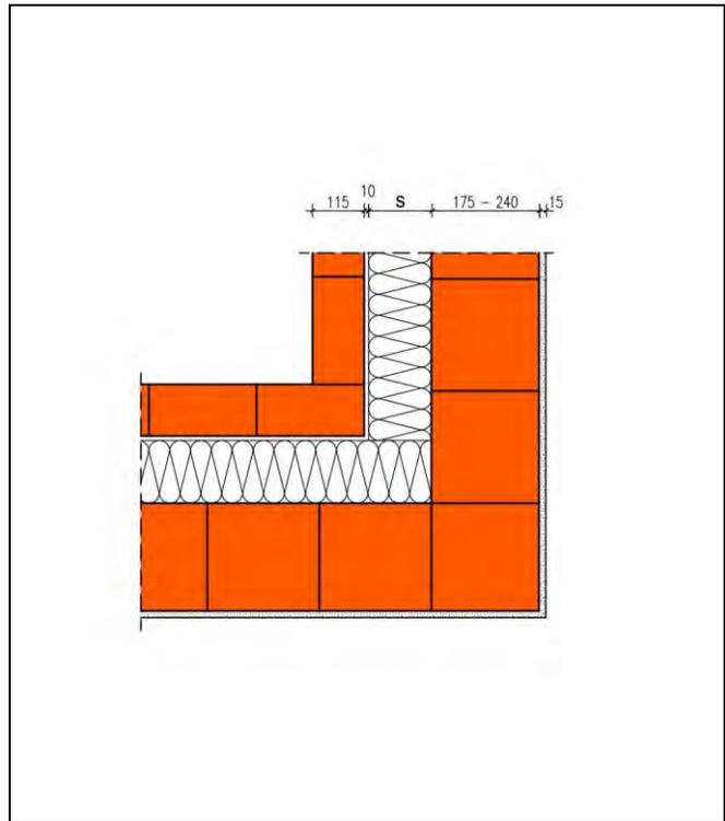
Die Berechnung des längenbezogenen Wärmedurchgangskoeffizienten erfolgt in Abhängigkeit unterschiedlicher Dämmstoffdicken  $s$  und Wärmeleitfähigkeiten des Hintermauerwerks bzw. einer Stahlbetonwand für die Wanddicken 175-240 mm. Bei davon abweichenden größeren Wanddicken der Hintermauerung ergeben sich geringfügig günstigere  $\Psi$ -Werte. Die  $\Psi$ -Werte gelten auch für Dicken der Vormauerschale  $\geq 90$  mm.
