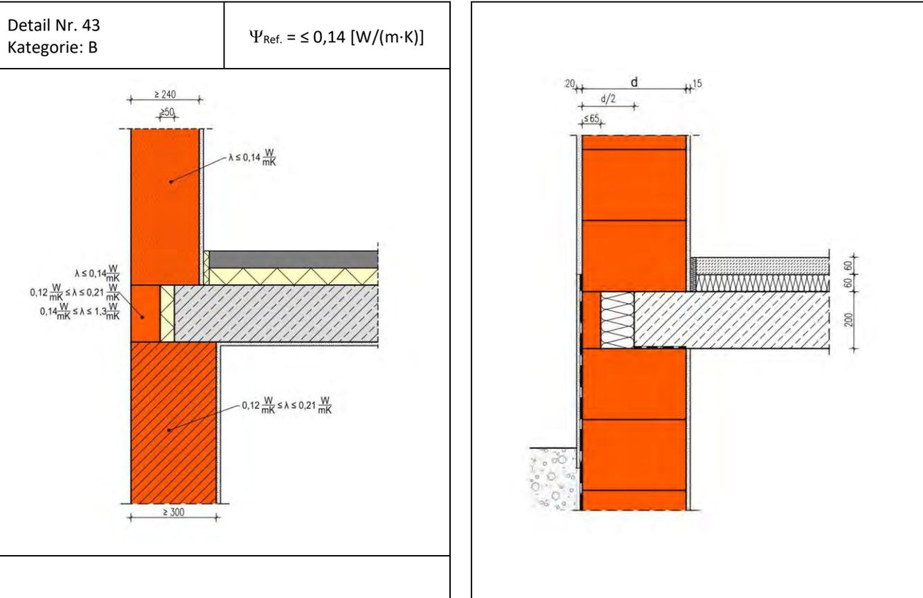
Die Berechnung des längenbezogenen Wärmedurchgangskoeffizienten erfolgt in Abhängigkeit unterschiedlicher Wanddicken d und Wärmeleitfähigkeiten des Mauerwerks.
