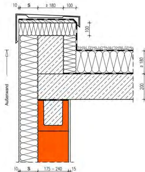
Die Berechnung des längenbezogenen Wärmedurchgangskoeffizienten erfolgt in Abhängigkeit unterschiedlicher Dämmstoffdicken  $S$  des Wärmedämm-Verbundsystems und Wärmeleitfähigkeiten des Hintermauerwerks für die Wanddicken 175 - 240 mm.
