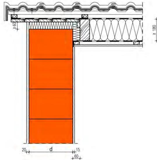
Die Berechnung des längenbezogenen Wärmedurchgangskoeffizienten erfolgt in Abhängigkeit unterschiedlicher Wanddicken  $d$  und Wärmeleitfähigkeiten des Mauerwerks und wird zur besseren Vergleichbarkeit mit Beiblatt 2 DIN 4108 auf den U-Wert des Gefaches bezogen. Die Rechenergebnisse gelten für Dicken der Dachdämmung zwischen 180 und 300 mm der Wärmeleitfähigkeit  $0,035 \text{ W/(m}\cdot\text{K)}$ .
