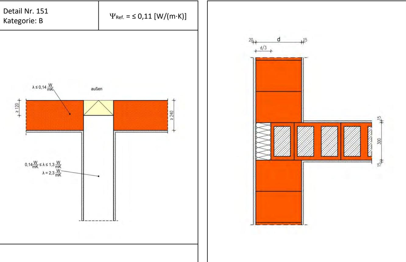
Die Berechnung des längenbezogenen Wärmedurchgangskoeffizienten erfolgt in Abhängigkeit unterschiedlicher Wanddicken  $d$  und Wärmeleitfähigkeiten des Außenmauerwerks. Die 30 cm dicke Wohnungstrennwand ist als Füllziegelwand mit einer Wärmeleitfähigkeit von  $0,96 \text{ W/(m}\cdot\text{K)}$  ausgeführt und mit einer  $d/3$  Stirndämmung der Wärmeleitfähigkeit  $0,035 \text{ W/(m}\cdot\text{K)}$  in die Außenwand eingebunden.
