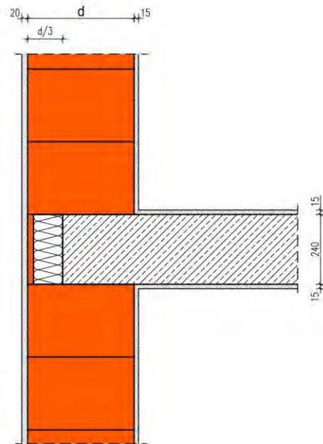
Die Berechnung des längenbezogenen Wärmedurchgangskoeffizienten erfolgt in Abhängigkeit unterschiedlicher Wanddicken  $d$  und Wärmeleitfähigkeiten des Außenmauerwerks. Die 24 cm dicke Wohnungstrennwand ist als Stahlbetonwand berechnet und mit einer 20 mm Ziegelblende als Putzträgerplatte und Stirndämmung der Wärmeleitfähigkeit  $0,035 \text{ W/(m}\cdot\text{K)}$  mit  $d/3$  in die Außenwand eingebunden.
