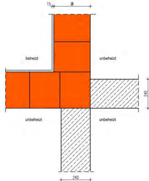
Die Berechnung des längenbezogenen Wärmedurchgangskoeffizienten erfolgt in Abhängigkeit unterschiedlicher Wanddicken  $d$  und Wärmeleitfähigkeiten des Kellermauerwerks zwischen beheiztem und unbeheiztem Keller. Der beheizte Bereich wird dreiseitig vom unbeheizten Keller umschlossen. Die Wärmeleitfähigkeit und Dicke der Wände im unbeheizten Keller hat einen zu vernachlässigenden Einfluss auf den  $\Psi$ -Wert. Der Keller weist eine Kellertemperatur von  $10^\circ\text{C}$  auf.
