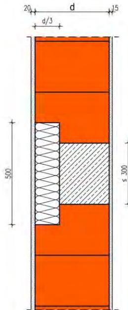
Die Berechnung des längenbezogenen Wärmedurchgangskoeffizienten erfolgt in Abhängigkeit unterschiedlicher Wanddicken  $d$  und Wärmeleitfähigkeiten des Mauerwerks. Die Dicke der Wärmedämmung vor der 300 mm breiten Stahlbetonstütze beträgt  $d/3$  d.h. 100 - 160 mm, deren Wärmeleitfähigkeit 0,035 W/(m·K).
