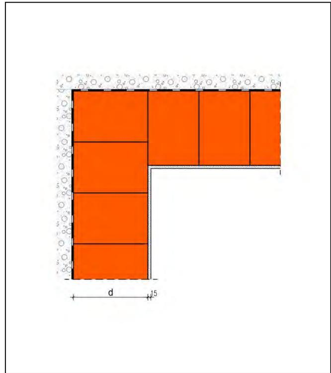
Die Berechnung des längenbezogenen Wärmedurchgangskoeffizienten erfolgt in Abhängigkeit unterschiedlicher Wanddicken  $d$  und Wärmeleitfähigkeiten des Mauerwerks im Erdreich.
