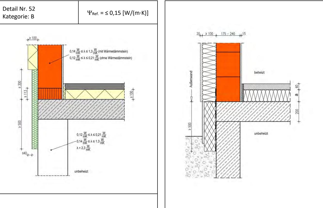
Die Berechnung des längenbezogenen Wärmedurchgangskoeffizienten erfolgt in Abhängigkeit unterschiedlicher Dämmstoffdicken a der Estrichdämmung der Wärmeleitfähigkeit 0,035 W/(m·K) und der Wärmeleitfähigkeiten des Hintermauerwerks im EG für Wanddicken 175 - 240 mm. Die Kellertemperatur beträgt 10 °C.
