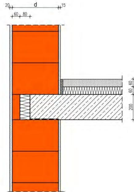
Die Berechnung des längenbezogenen Wärmedurchgangskoeffizienten erfolgt in Abhängigkeit unterschiedlicher Wanddicken  $d$  Wärmeleitfähigkeiten des Mauerwerks. Die Dicke der Wärmedämmung hinter der 60 mm Ziegelschale beträgt 80 mm mit einer Wärmeleitfähigkeit  $\leq 0,035 \text{ W/(m}\cdot\text{K)}$ .
