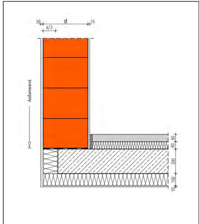
Die Berechnung des längenbezogenen Wärmedurchgangskoeffizienten erfolgt in Abhängigkeit unterschiedlicher Wanddicken  $d$  und Wärmeleitfähigkeiten des Mauerwerks. Die Stahlbetondecke ist stirnseitig mit  $d/3$  d.h. 100 bis 160 mm, an der Unterseite mit 100 mm Wärmedämmung der Wärmeleitfähigkeit 0,035 W/(m·K) ausgeführt. Der U-Wert der Decke beträgt 0,21 W/(m<sup>2</sup> K). Die Systemgrenze des beheizten Bereichs liegt unterhalb der Estrichdämmung auf der Rohdecke.
