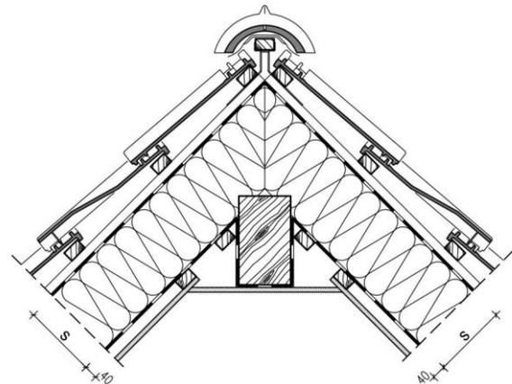
Die Berechnung des längenbezogenen Wärmedurchgangskoeffizienten erfolgt in Abhängigkeit unterschiedlicher Dämmstoffdicken  $S$  und Wärmeleitfähigkeiten der Dachdämmung. Bei der Dämmstoffdicke 240 mm wird eine Zwischsparrendämmung von 200 mm und eine Untersparrendämmung von 40 mm Dicke zugrunde gelegt. Die  $\Psi$ -Werte werden auf den U-Wert des Gefachs bezogen.
