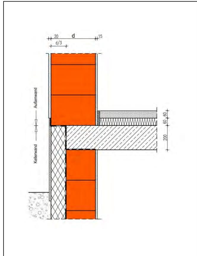
Die Berechnung des längenbezogenen Wärmedurchgangskoeffizienten erfolgt in Abhängigkeit unterschiedlicher Wanddicken  $d$  und Wärmeleitfähigkeiten des Außenmauerwerks im EG.
