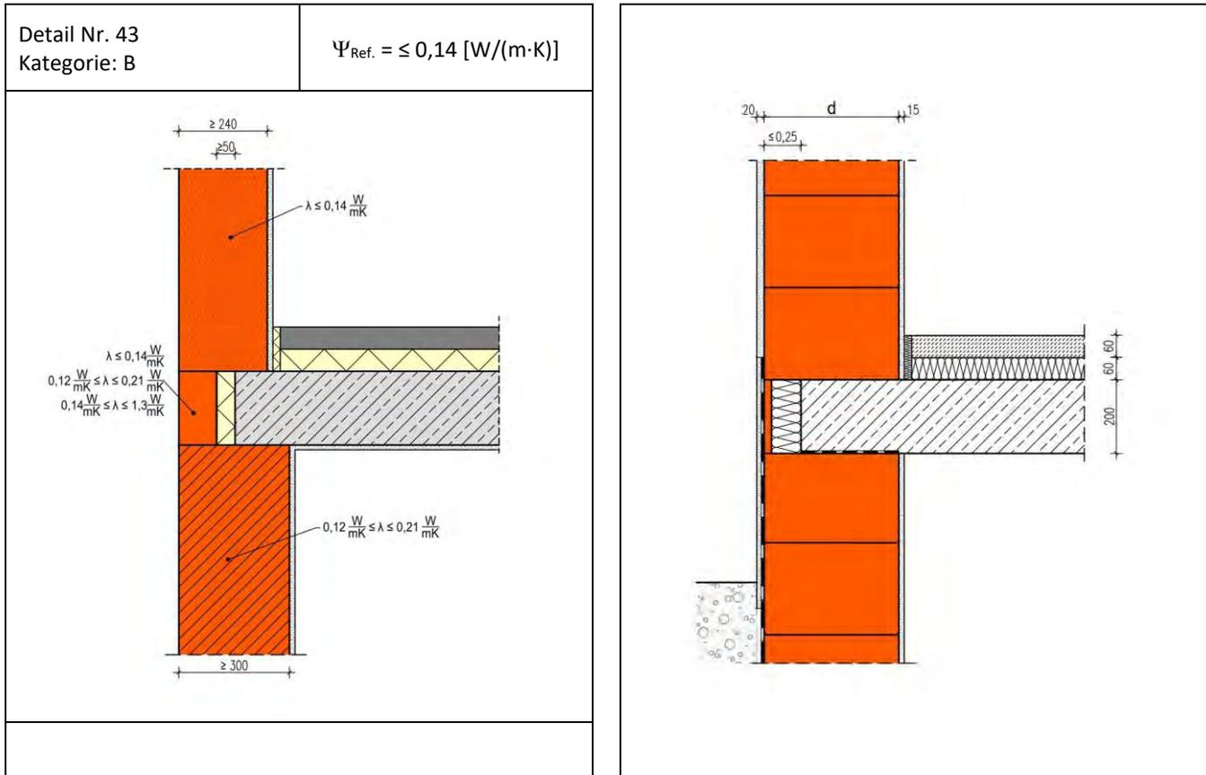
Die Berechnung des längenbezogenen Wärmedurchgangskoeffizienten erfolgt in Abhängigkeit unterschiedlicher Wanddicken  $d$  und Wärmeleitfähigkeiten des Mauerwerks für eine Deckenauflager mit etwa 75 % der Wanddicke.
