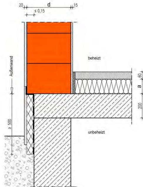
Die Berechnung des längenbezogenen Wärmedurchgangskoeffizienten erfolgt in Abhängigkeit unterschiedlicher Wanddicken  $d$  des Außenmauerwerks im EG und Dicken  $a$  der Estrichdämmung. Die Kellertemperatur beträgt  $10^\circ\text{C}$ .
