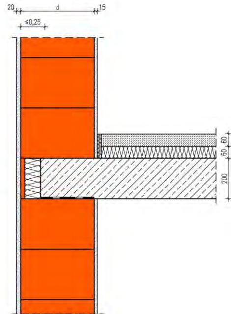
Die Berechnung des längenbezogenen Wärmedurchgangskoeffizienten erfolgt in Abhängigkeit unterschiedlicher Wanddicken d und Wärmeleitfähigkeiten des Mauerwerks für eine Deckenaufлагer mit etwa 75 % der Wanddicke. Die Dicke des Deckenrandelements aus Ziegelschale und Wärmedämmung beträgt maximal 0,25 d mit einer Wärmeleitfähigkeit des Dämmstoffs  $\leq 0,035 \text{ W/(m}\cdot\text{K)}$ . Die Werte gelten für Dicken der Stahlbetondecke zwischen 180 und 250 mm.
