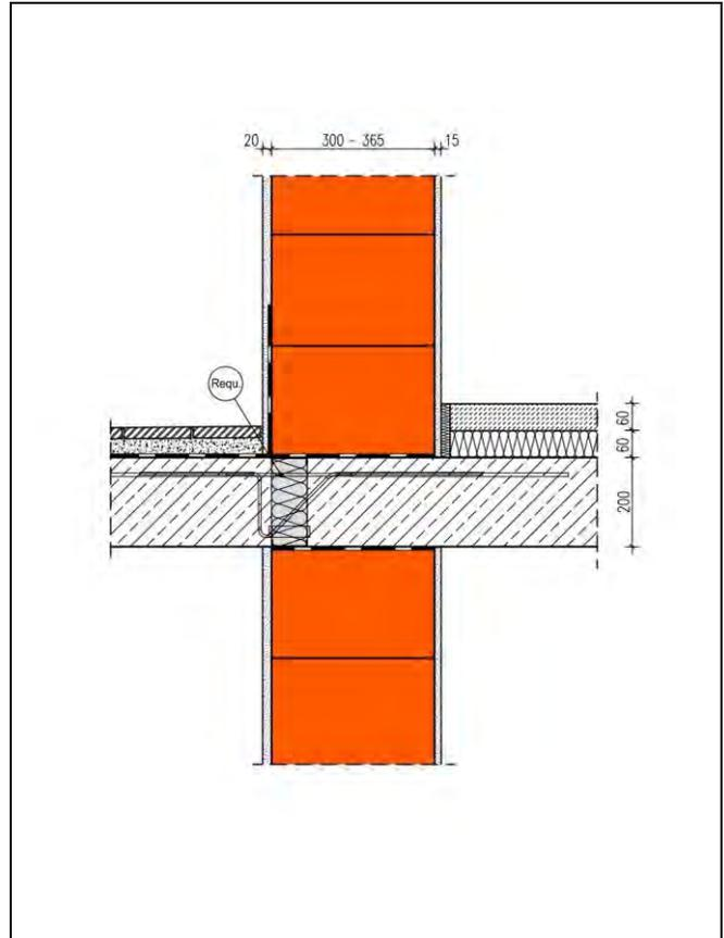
Die Berechnung des längenbezogenen Wärmedurchgangskoeffizienten erfolgt in Abhängigkeit unterschiedlicher Wärmeleitfähigkeiten des Außenmauerwerks und verschiedener Wärmedurchlasswiderstände R-äquivalent der Dämmstoffkörper zur thermischen Entkopplung der Balkonplatte. Die Requ-Werte sinken mit zunehmendem Stahlanteil im Dämmelement. Das Dämmelement hat eine Dicke von 120 mm. Die Rechenergebnisse gelten für Dicken der Außenwände zwischen 300 und 365 mm.
