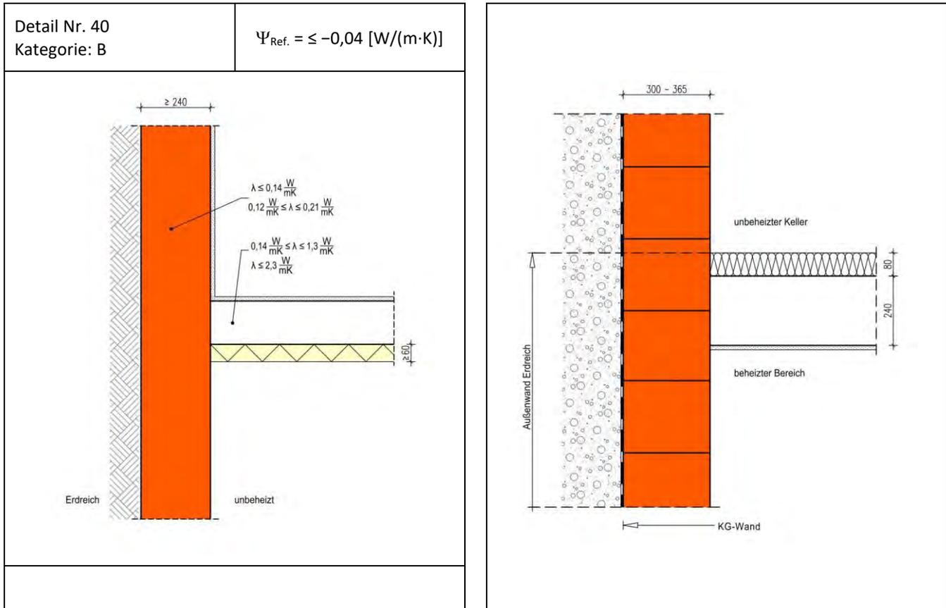
Die Berechnung des längenbezogenen Wärmedurchgangskoeffizienten erfolgt in Abhängigkeit unterschiedlicher Wärmeleitfähigkeiten des Außen- und Innenmauerwerks. Die Systemgrenze der Wände verläuft außenseitig auf der Kaltseite (Erdreich bzw. unbeheizter Keller). Der Temperaturkorrekturfaktor  $F_{\text{bw}}$  und  $F_{\text{bf}}$  beträgt 0,6. Die Rechenergebnisse gelten für Wanddicken der Außenwände zwischen 300 und 365 mm.
