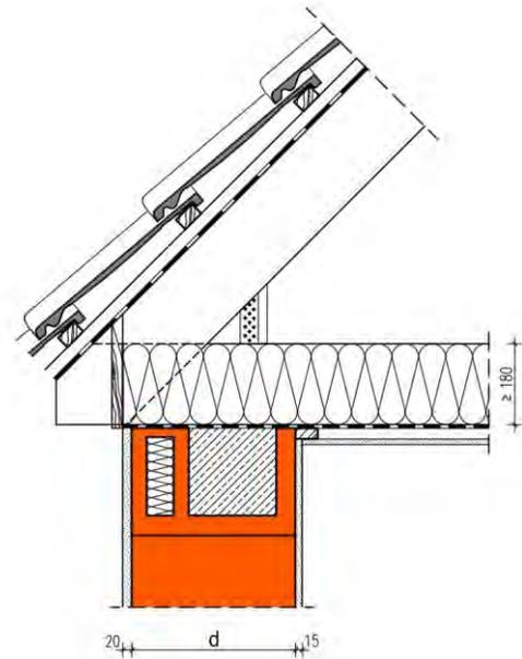
Die Berechnung des längenbezogenen Wärmedurchgangskoeffizienten erfolgt in Abhängigkeit unterschiedlicher Wanddicken  $d$  und Wärmeleitfähigkeiten des Mauerwerks und wird zur besseren Vergleichbarkeit mit DIN 4108 Beiblatt 2 auf den U-Wert des Gefachs der Kehlbalke Lage bezogen. Die Wärmedämmung zwischen den Kehlbalcken weist eine Mindestdicke von 180 mm der Wärmeleitfähigkeit  $0,035 \text{ W/(m}\cdot\text{K)}$  auf. Der U-Wert der Holzbalkendecke beträgt  $\leq 0,2 \text{ W/(m}^2\text{K)}$ .
