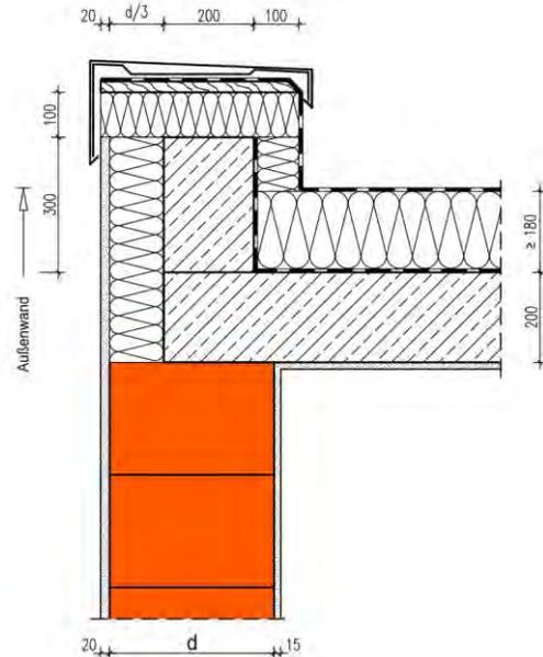
Die Berechnung des längenbezogenen Wärmedurchgangskoeffizienten erfolgt in Abhängigkeit unterschiedlicher Wanddicken  $d$  und Wärmeleitfähigkeiten des Mauerwerks.
