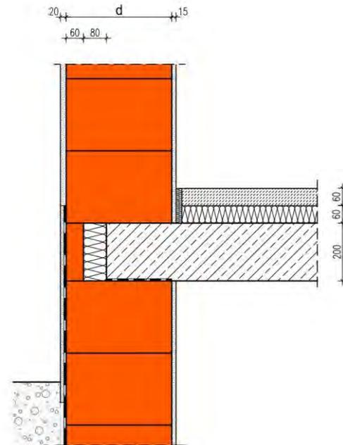
Die Berechnung des langenzugeordneten Warmedurchgangskoeffizienten erfolgt in Abhangigkeit unterschiedlicher Wanddicken  $d$  und Warmeleitfahigkeiten des Mauerwerks.
