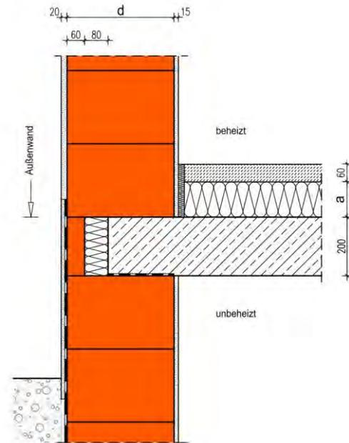
Die Berechnung des längenbezogenen Wärmedurchgangskoeffizienten erfolgt in Abhängigkeit unterschiedlicher Wanddicken  $d$  des Außenmauerwerks im EG und Dämmstoffdicken  $a$  der Estrichdämmung. Die Kellertemperatur beträgt 10 °C.
