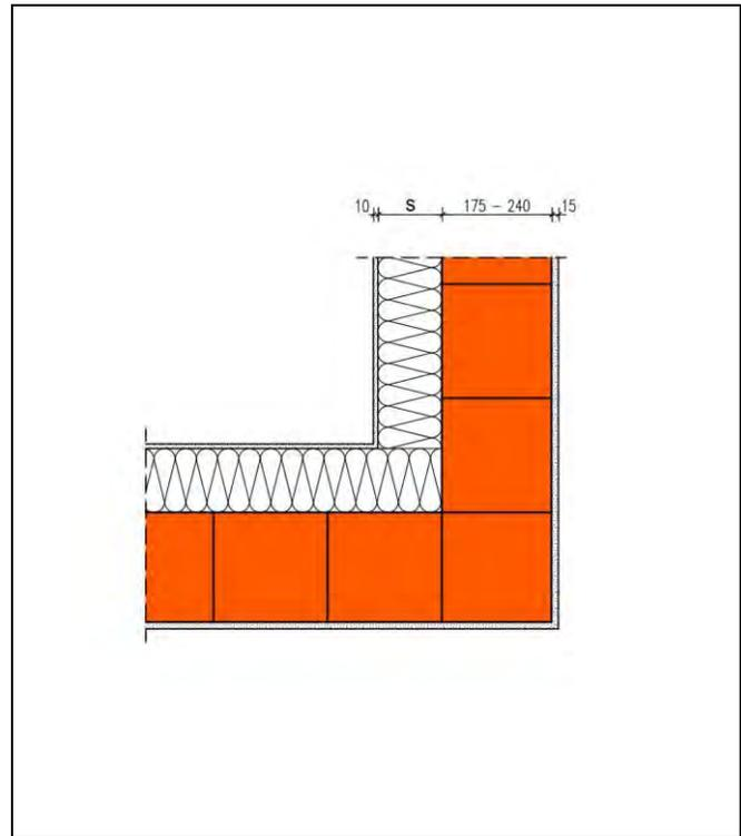
Die Berechnung des längenbezogenen Wärmedurchgangskoeffizienten erfolgt in Abhängigkeit unterschiedlicher Dämmstoffdicken  $s$  und Wärmeleitfähigkeiten des Hintermauerwerks bzw. einer Stahlbetonwand für die Wanddicken 175-240 mm. Bei davon abweichenden größeren Wanddicken der Hintermauerung ergeben sich geringfügig günstigere  $\Psi$ -Werte.
