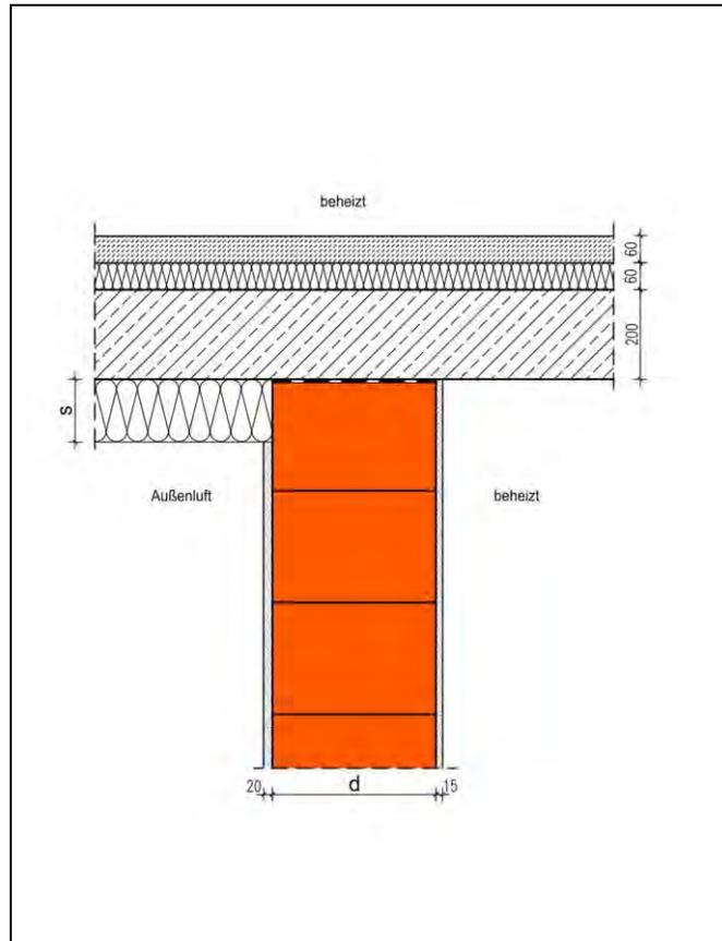
Die Berechnung des längenbezogenen Wärmedurchgangskoeffizienten erfolgt in Abhängigkeit unterschiedlicher Wärmeleitfähigkeiten des Mauerwerks und Dicken  $s$  der Wärmedämmung unterhalb der Decke. Die Dicke der Außenwand hat einen zu vernachlässigenden Einfluss auf den  $\Psi$ -Wert. Die Zahlenwerte gelten für Mauerwerk der Dicken zwischen 300 und 490 mm.
