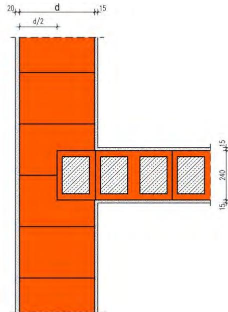
Die Berechnung des längenbezogenen Wärmedurchgangskoeffizienten erfolgt in Abhängigkeit unterschiedlicher Wanddicken  $d$  und Wärmeleitfähigkeiten des Außenmauerwerks. Die 24 cm dicke Wohnungstrennwand ist als Füllziegelwand mit einer Wärmeleitfähigkeit von 0,96  $\text{W/(m}\cdot\text{K)}$  ausgeführt und etwa  $d/2$  von der Raumseite eingebunden.
