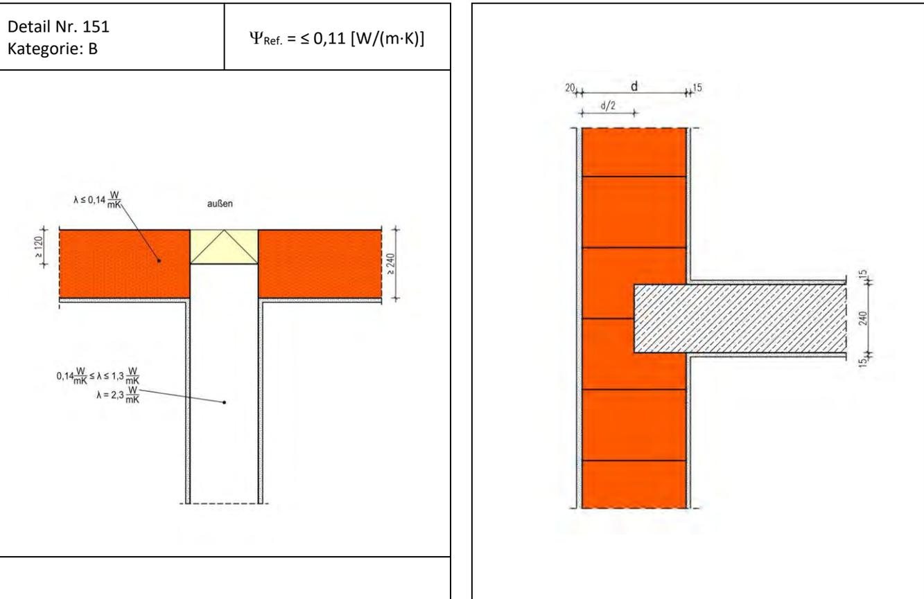
Die Berechnung des längenbezogenen Wärmedurchgangskoeffizienten erfolgt in Abhängigkeit unterschiedlicher Wanddicken d und Wärmeleitfähigkeiten des Außenmauerwerks. Die 24 cm dicke Wohnungstrennwand ist als Stahlbetonwand berechnet und etwa d/2 von der Raumseite eingebunden.
