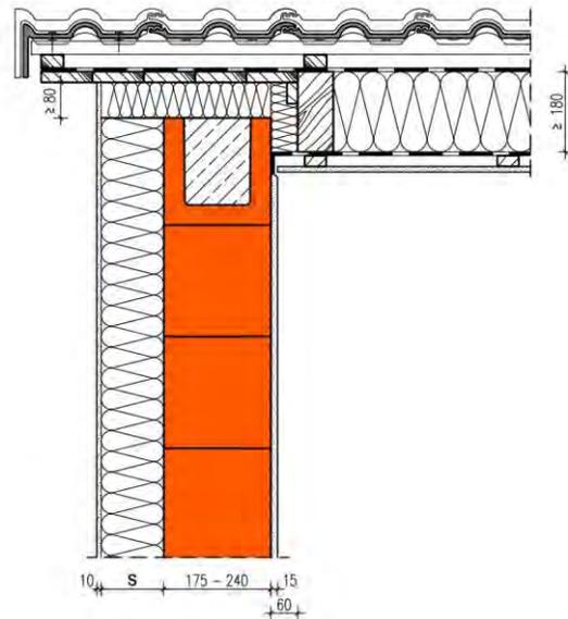
Die Berechnung des längenbezogenen Wärmedurchgangskoeffizienten erfolgt in Abhängigkeit unterschiedlicher Dämmstoffdicken  $S$  des WDVS und Wärmeleitfähigkeiten des Hintermauerwerks für die Wanddicke 175 - 240 mm. Zur besseren Vergleichbarkeit mit Beiblatt 2 DIN 4108 wird der  $\Psi$ -Wert auf den U-Wert des Gefachs bezogen. Die Rechenergebnisse gelten für Dicken der Dachdämmung zwischen 180 und 300 mm der Wärmeleitfähigkeit 0,035 W/(m·K).
