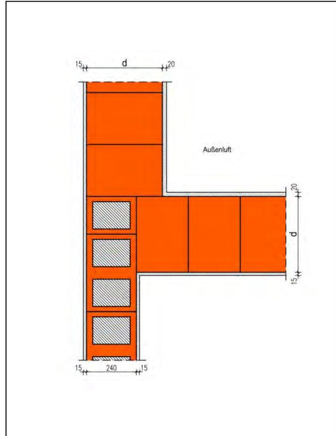
Die Berechnung des längenbezogenen Wärmedurchgangskoeffizienten erfolgt in Abhängigkeit unterschiedlicher Wanddicken  $d$  und Wärmeleitfähigkeiten des Außenmauerwerks. Die 24 cm dicke Wohnungstrennwand ist als Füllziegelwand mit einer Wärmeleitfähigkeit von  $0,96 \text{ W/(m}\cdot\text{K)}$  ausgeführt und mit voller Wanddicke von 24 cm in die abknickende Außenwand eingebunden.
