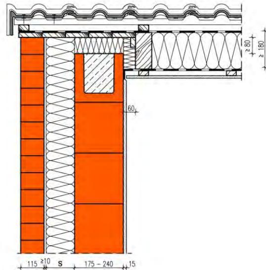
Die Berechnung des längenbezogenen Wärmedurchgangskoeffizienten erfolgt in Abhängigkeit unterschiedlicher Dämmstoffdicken  $S$  der Wärmedämmung und Wärmeleitfähigkeiten des Hintermauerwerks für die Wanddicke 175 - 240 mm. Zur besseren Vergleichbarkeit mit Beiblatt 2 DIN 4108 wird der  $\Psi$ -Wert auf den U-Wert des Gefachs bezogen. Die Rechenergebnisse gelten für Dicken der Dachdämmung zwischen 180 und 300 mm der Wärmeleitfähigkeit 0,035 W/(m·K).
