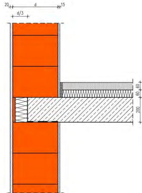
Die Berechnung des längenbezogenen Wärmedurchgangskoeffizienten erfolgt in Abhängigkeit unterschiedlicher Wanddicken d Wärmeleitfähigkeiten des Mauerwerks. Die Dicke der Wärmedämmung hinter der 20 mm Ziegelblende beträgt zwischen 80 bis 140 mm mit einer Wärmeleitfähigkeit  $\leq 0,035 \text{ W/(m}\cdot\text{K)}$ .
