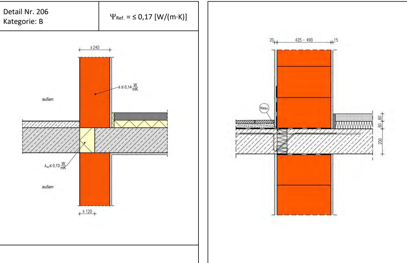
Die Berechnung des längenbezogenen Wärmedurchgangskoeffizienten erfolgt in Abhängigkeit unterschiedlicher Wärmeleitfähigkeiten des Außenmauerwerks und verschiedener Wärmedurchlasswiderstände R-equivalent der Dämmstoffkörper zur thermischen Entkopplung der Balkonplatte. Die Requ-Werte sinken mit zunehmendem Stahlanteil im Dämmelement. Das Dämmelement hat eine Dicke von 120 mm. Die Rechenergebnisse gelten für Dicken der Außenwände zwischen 425 und 490 mm.
