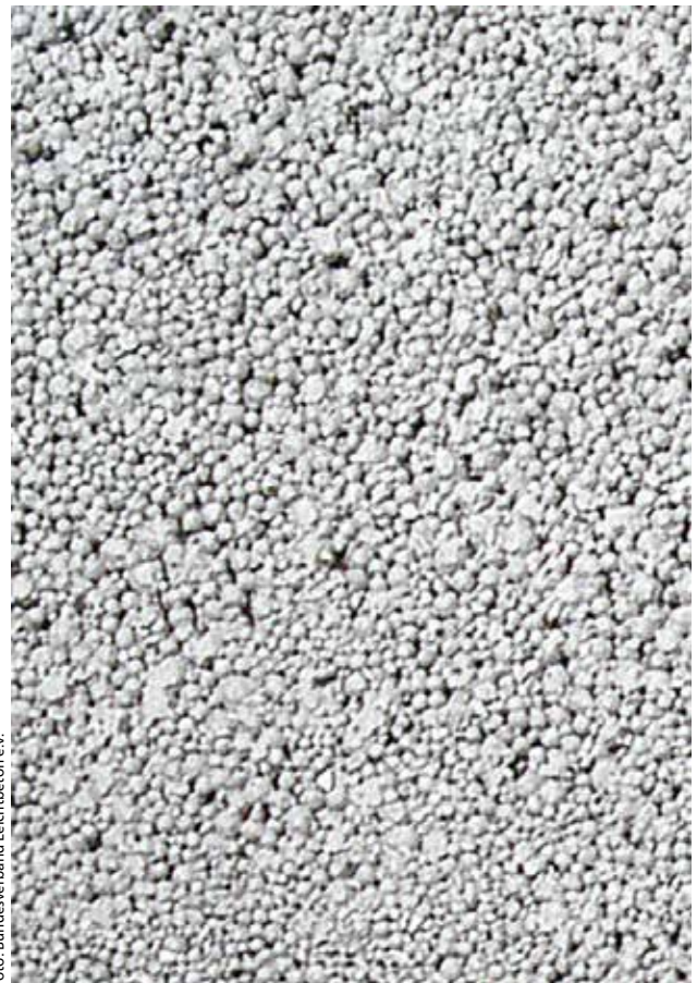
Beton mit haufwerksporiger Oberfläche
